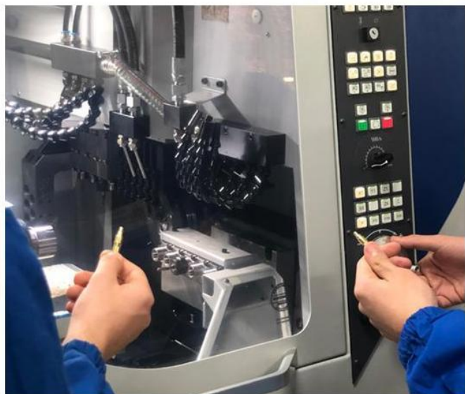
Pezzi realizzati dagli studenti del CNOS-FAP di Arese con il tornio a fantina mobile Tornos CT20
