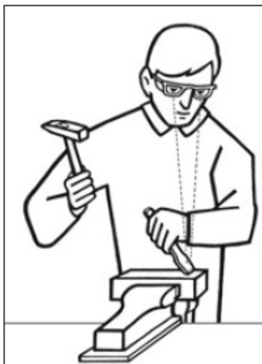
Figura 9: modo corretto di usare lo scalpello: pezzo da lavorare fissato nella morsa, martello tenuto saldamente in mano, sguardo rivolto al tagliente dello scalpello, occhiali di protezione.
