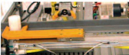
la presenza dell'oggetto quindi arresterà il nastro trasportatore **NASTRO\_1** e riporterà la guida nella posizione utile, attraverso la disattivazione dell'elettrovalvola **YV1**.
