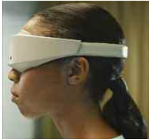
grossi occhiali. Sono visori “bidirezionali”, con piccoli display che proiettano immagini davanti agli occhi, auricolari che trasmettono suoni e una serie di sensori che forniscono al sistema informazioni su posizione e orientamento della testa, movimento degli occhi ed espressioni del viso. Muovendo la testa e il corpo possiamo guardarci intorno in ogni direzione, con una forte illusione di realtà. E, se sorridiamo, il sistema lo sa.
