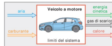
Figura 1: Rappresentazione del sistema generale sull'esempio di un'autovettura
