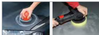
Figura 2: Lucidatura a mano e con lucidatrice
