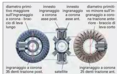
Figura 2: Ripartizione di base nel differenziale a corona
