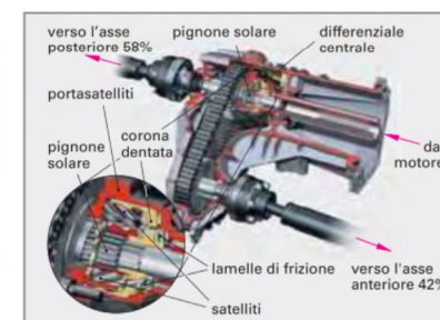
Figura 4: Differenziale centrale autobloccante
