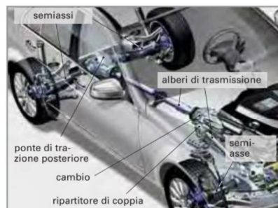
Figura 2: Catena cinematica di una trazione integrale
