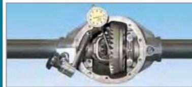
Figura 1: Rilevazione del gioco del fianco del dente
