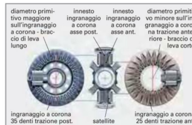
Figura 2: Ripartizione di base nel differenziale a corona
