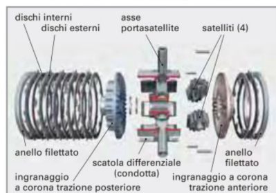
Figura 1: Componenti del differenziale a corona
