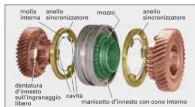
Figura 3: Sincronizzatore ad anello rovesciato
