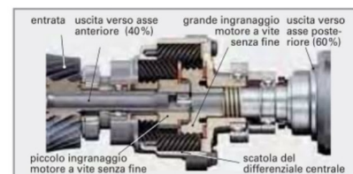
Figura 1: Differenziale Torsen come bloccaggio longitudinale con ripartizione non omogenea della coppia
