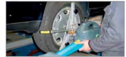
Figura 2: Posizionamento dei rilevatori
