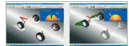
Figura 4: Determinazione dei valori della convergenza
