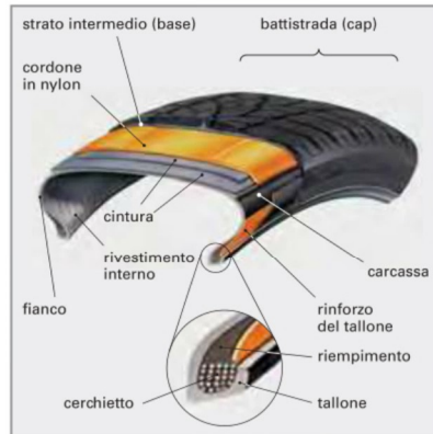
Figura 1: Struttura di un pneumatico radiale per autovetture
