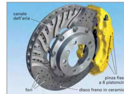
Figura 3: Disco in ceramica a ventilazione interna
