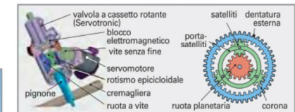
Figura 2: Riduttore e rotismo epicicloidale
