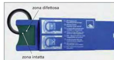
Figura 3: Cuscinetto per ruote con anello multipolare difettoso
