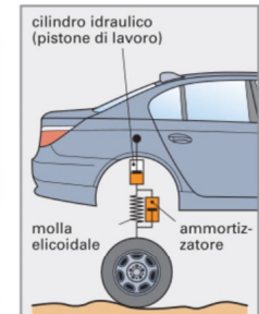
Figura 1: Ammortizzatore McPherson con pistone di lavoro
