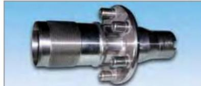
Figura 3: Mozzo ruota in titanio per auto da corsa di F1
