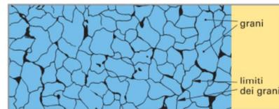
Figura 2: Immagine micrografica della struttura metallica
