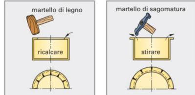
Figura 1: Bordatura interna      Figura 2: Bordatura esterna
