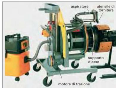
Figura 4: Apparecchio di tornitura per guarnizioni di ceppi freno
