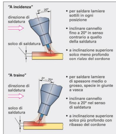
Figura 1: Saldatura a incidenza e a traino
