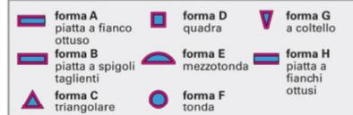
Figura 2: Sigle di riconoscimento per sezioni di lima
