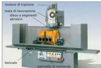
Figura 5: Macchina rettificatrice-fresatrice per blocchi e testate motore
