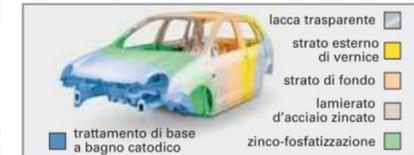
Figura 5: Composizione di una verniciatura di automobile
