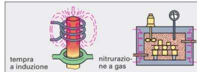
Figura 5: Modifica delle proprietà del materiale
