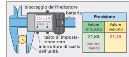
Figura 4: Calibro a corsoio elettronico con indicatore numerico
