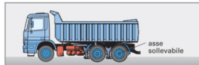
Figura 1: Veicolo a tre assi 6x2
