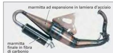
Figura 4: Impianto di scarico per scooter
