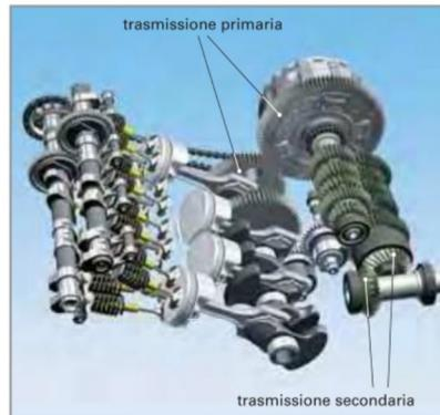
Figura 1: Motore da moto con trasmissione primaria
