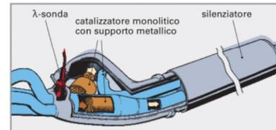
Figura 1: Impianto di scarico con catalizzatore a tre vie
