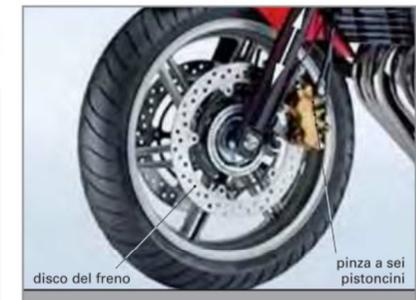
Figura 2: Freno a disco sulla ruota anteriore
