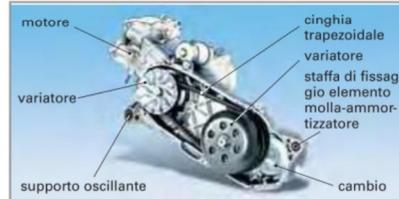
Figura 2: Braccio oscillante propulsore
