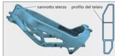
Figura 5: Telaio perimetrale in alluminio
