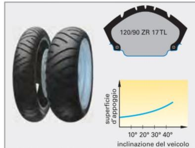
Figura 1: Profilo dello pneumatico da motociclo
