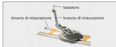
Figura 1: Sistema di misurazione elettronico
