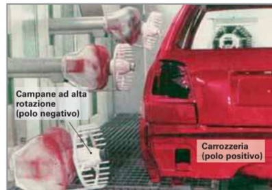
Figura 2: Procedimento di spruzzatura elettrostatica
