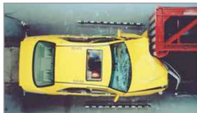
Figura 2: Crash frontale spostato verso il lato sinistro (sovrapposizione = 50%, Offset)
