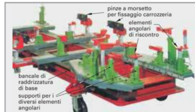
Figura 2: Banco raddrizzatore con elementi angolari di riscontro
