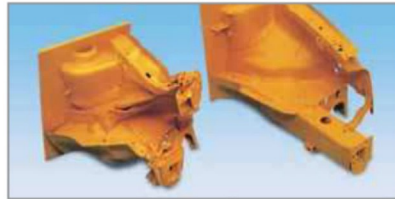
Figura 4: Assorbimento dell'urto da parte di un longherone anteriore
