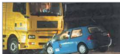
Figura 3: Effetto di una protezione anti-intrusione ad assorbimento di energia in una collisione con un veicolo pesante
