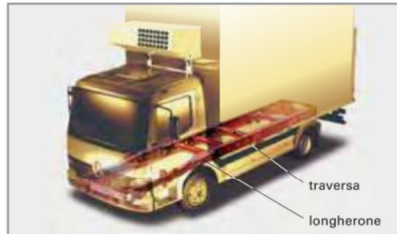
Figura 1: Struttura e telaio portante
