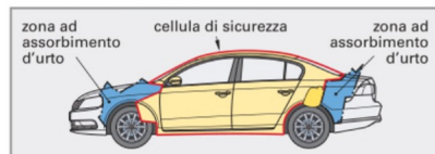
Figura 3: Carrozzeria di sicurezza
