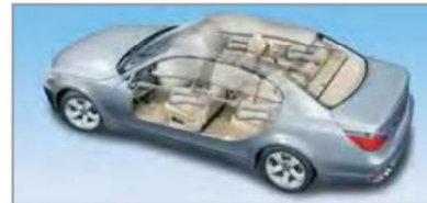
Figura 2: Disposizione degli airbag nell'abitacolo
