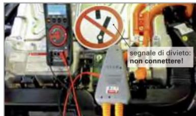
Figura 2: Segnale di "Vietato alterare lo stato dell'interruttore"
