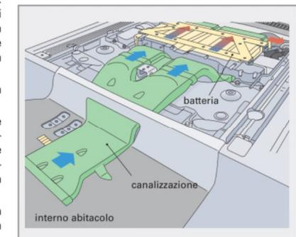
Figura 2: Ventilazione degli accumulatori
