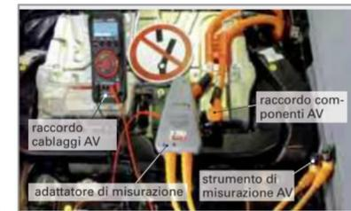
Figura 3: Impianto di misurazione per il controllo della resistenza di isolamento
