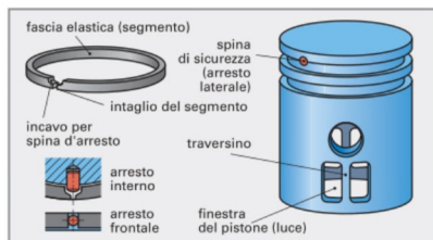
Figura 2: Pistone monometallico con finestre
