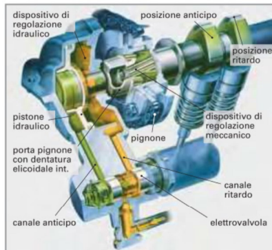
Figura 2: Struttura di un variatore di fase sull'albero a camme
