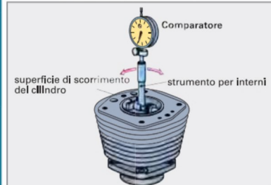
Figura 2: Misurazione della superficie di scorrimento del cilindro
