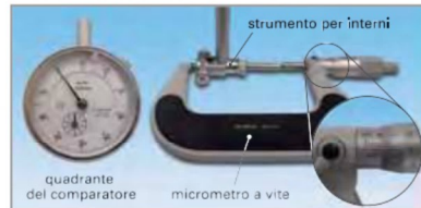
Figura 4: "Taratura" del comparatore
