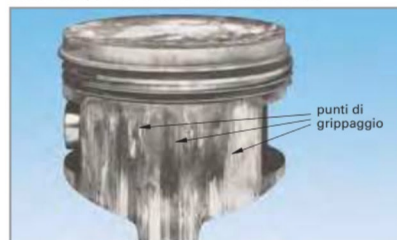
Figura 3: Grippaggio del mantello
