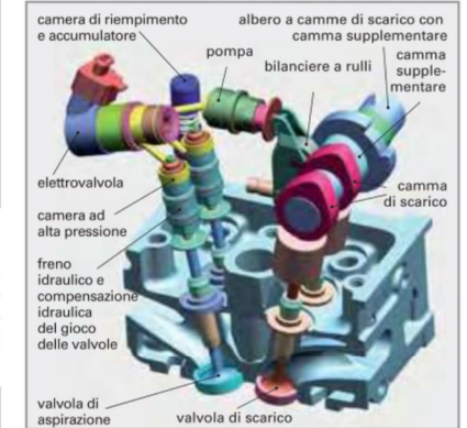
Figura 3: Schema funzionale di una distribuzione elettroidraulica completamente variabile
