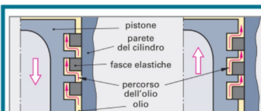
Figura 1: Fasce elastiche "pompanti"
