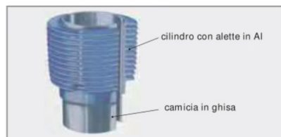
Figura 1: Cilindro raffreddato ad aria prodotto con fusione mista Fe-Al
