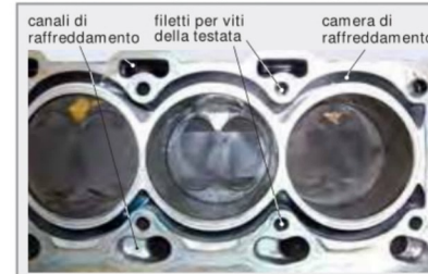
Figura 1: Blocco cilindri di tipo "open-deck"
