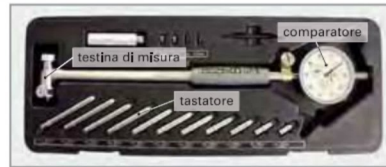
Figura 3: Micrometro per interni con comparatore e tastatori
