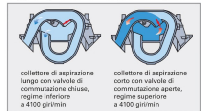
Figura 2: Sistema di collettori di aspirazione oscillanti di un motore a V
