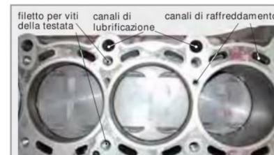
Figura 2: Blocco cilindri di tipo "closed-deck"
