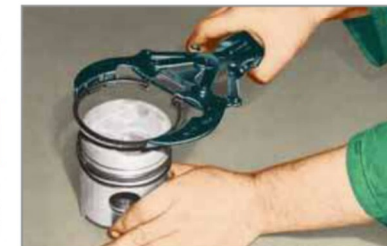
Figura 3: Montaggio delle fasce elastiche con pinza speciale
