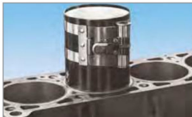
Figura 1: Montaggio del pistone nel cilindro
