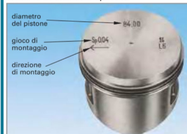
Figura 2: Indicazioni di montaggio sul cielo del pistone
