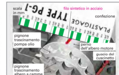
Figura 2: Misurazione del gioco del cuscinetto con plastigage.
