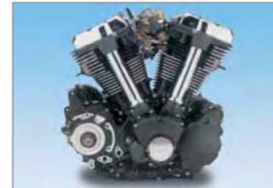
Figura 1: Motore raffreddato ad aria con alette di raffreddamento
