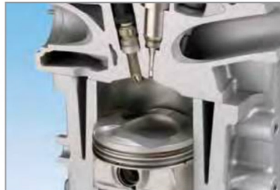
Figura 1: Camera di combustione con miscelazione guidata dal getto
