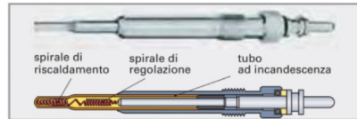
Figura 3: Candelette a perno con comando elettronico in acciaio
