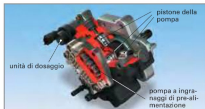
Figura 2: Pompa ad alta pressione CP3 con unità di dosaggio e pompa di pre-alimentazione ad ingranaggi
