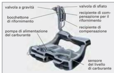
Figura 2: Serbatoio del carburante in PE per autovetture
