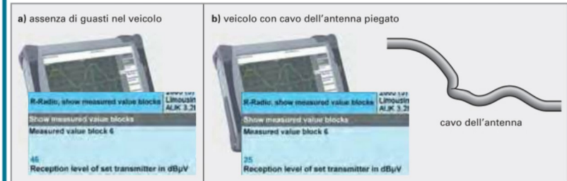
Figura 1: Misura intensità di campo con tester diagnosi
