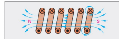
Figura 2: Campo magnetico all'interno di una bobina
