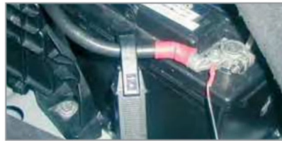
Figura 3: Misura della corrente di carica con una pinza induttiva
