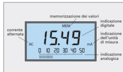
Figura 1: Indicazione digitale con indicazione analogica lineare incorporata
