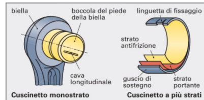
Figura 1: Cuscinetto monostrato e cuscinetto a più strati
