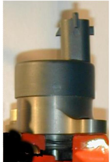
**CARATTERISTICHE:** il regolatore di pressione permette di regolare la pressione del combustibile presente nell'accumulatore; esso è costituito da un otturatore sferico mantenuto sulla sua sede conica da un'asta caricata da una molla e da una forza additiva generata da un solenoide, quando quest'ultimo è eccitato.
