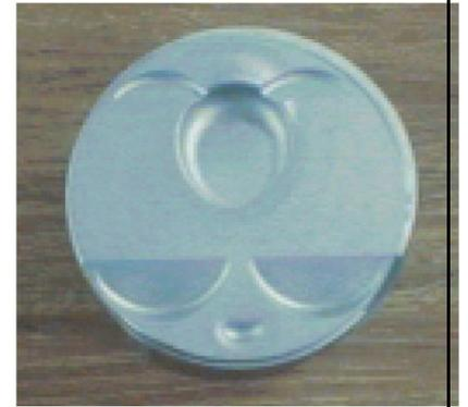
La stratificazione della miscela viene ottenuta ritardando l'iniezione del combustibile, il quale viene a sua volta spruzzato dentro una piccola conca ricavata sul cielo del pistone e che ha la funzione di deviare la benzina verso la candela.
