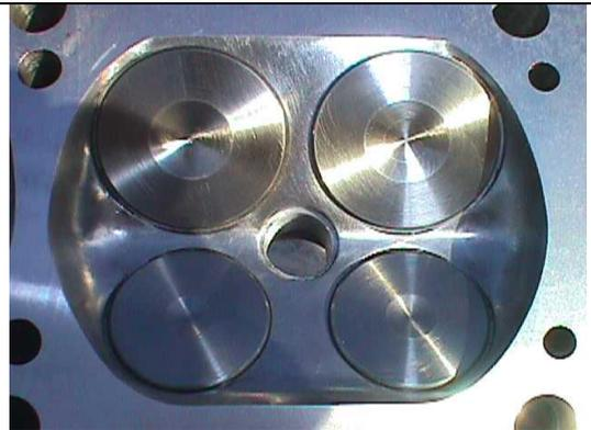
**FUNZIONE:** la testa cilindri è l'elemento che, assieme allo stantuffo e alla canna cilindro, delimita la camera entro cui avviene la successione delle fasi del ciclo termodinamico; la totalità degli attuali motori è munita di una testa cilindri riportata che è collegata al basamento per mezzo di viti prigioniere e dadi opportunamente disposti in modo da assicurare la tenuta tra testa cilindri e gruppo cilindri ed impedire deformazioni sotto l'azione del calore e della pressione.
