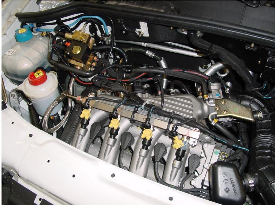
**RAIL:** il collettore di iniezione ha la funzione di ricevere il metano a bassa pressione uscente dal riduttore di pressione e di distribuirlo ai vari iniettori.
