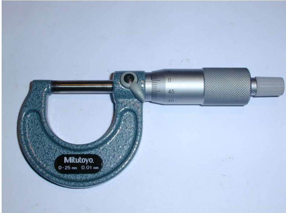
**UTILIZZO:** il micrometro centesimale per esterni è un strumento che permette di rilevare quote esterna con una approssimazione di 0,01 mm.
