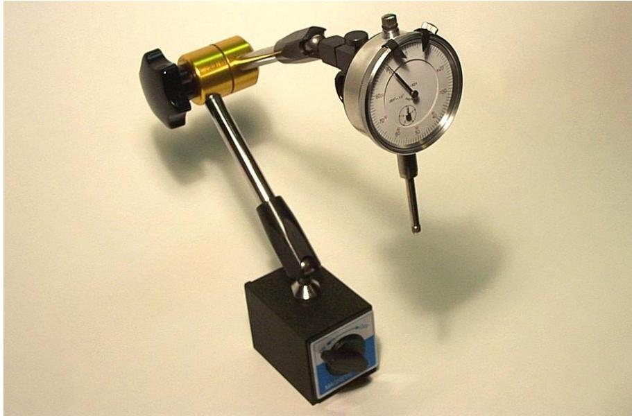
**UTILIZZO:** strumento di precisione atto a fornire la misura delle dimensioni di un oggetto per confronto con un campione, che può essere un blocchetto pian parallelo od un elemento geometrico qualsiasi, oppure un calibro fisso; con il comparatore non è quindi possibile rilevare la misura reale della dimensione incognita per lettura diretta, ma soltanto la differenza esistente fra essa e la dimensione campione.
