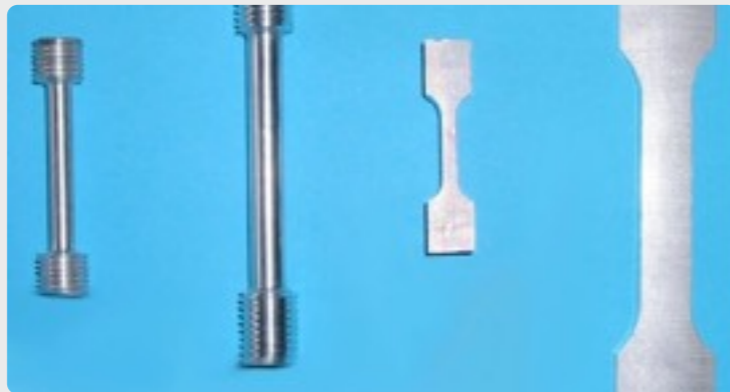
Galleria 3.5 Esempi di provini per la prova di trazione
