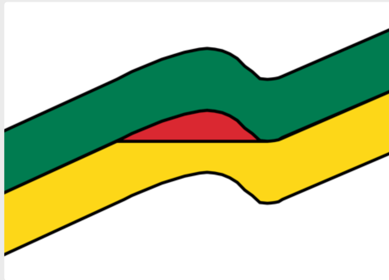
Schematizzazione della formazione di una sacca di petrolio nel sottosuolo
