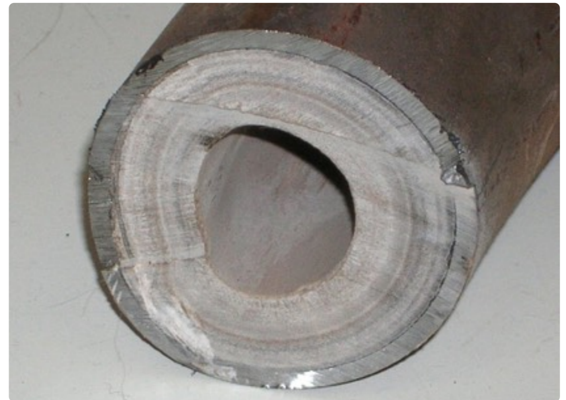
Sezione di un tubo di acciaio zincato parzialmente ostruito dal calcare
