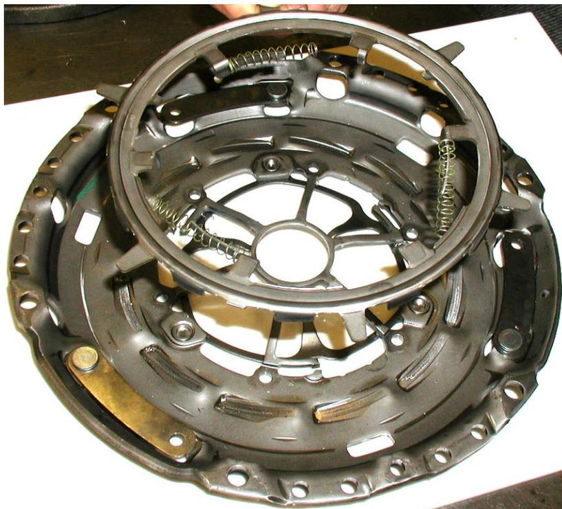
La frizione LUK è una frizione monodisco a secco con sistema di disinnesto a spinta; ciò significa che la manovra di disinnesto della frizione avviene quando il manicotto spinge la molla a diaframma, ribaltando la concavità della molla a diaframma.
