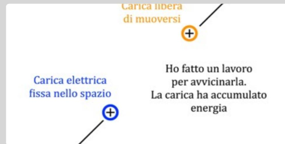
Per avvicinare una carica positiva ad un'altra devo sviluppare una forza per compiere il lavoro necessario. La carica acquista l'energia trasmessa tramite il lavoro
