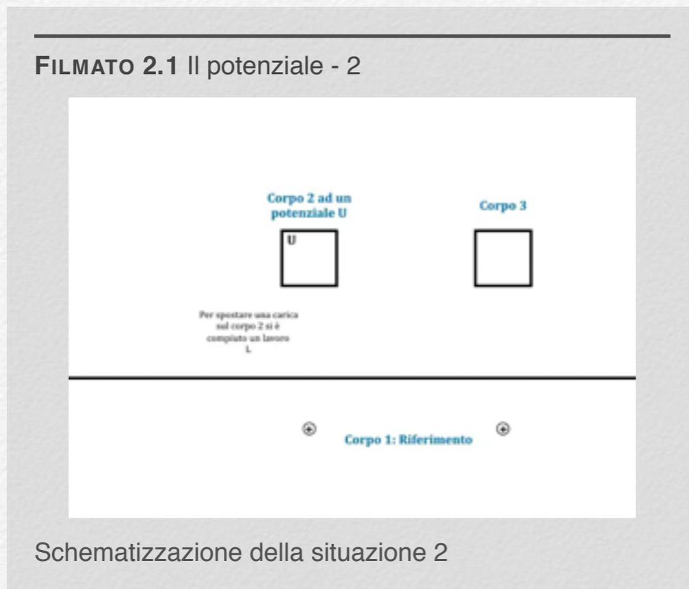
Si immagini adesso di voler spostare la stessa carica non sul secondo ma sul terzo conduttore. Se per eseguire il lavoro è necessario spendere il doppio dell'energia allora il terzo conduttore si trova ad un potenziale superiore al secondo e la carica, dopo lo spostamento, acquisterà più energia. Più precisamente poiché si deve compiere il doppio del lavoro significa che il terzo conduttore ha un potenziale che è il doppio.
