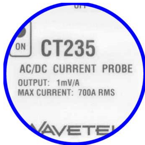
Inserzione della pinza amperometrica e suoi dati di targa.
