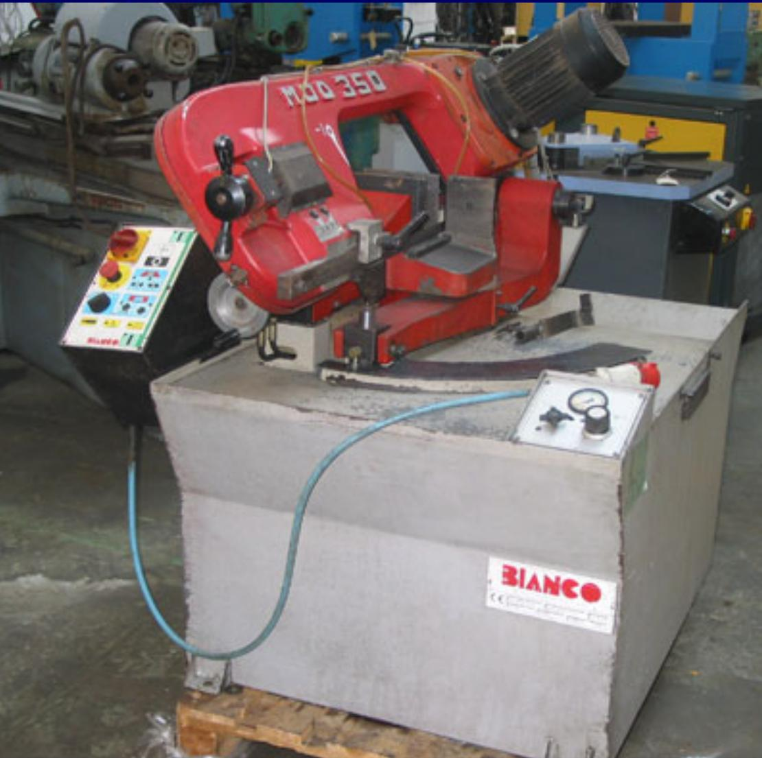
La sega a nastro è costituita da un nastro metallico flessibile che gira continuamente attorno a due o tre volani. Il nastro è dentellato come le comuni seghe a mano e la funzione principale di questo è il taglio lungo linee curve, ma può essere utilizzato anche per tagli longitudinali, trasversali, obliqui.
