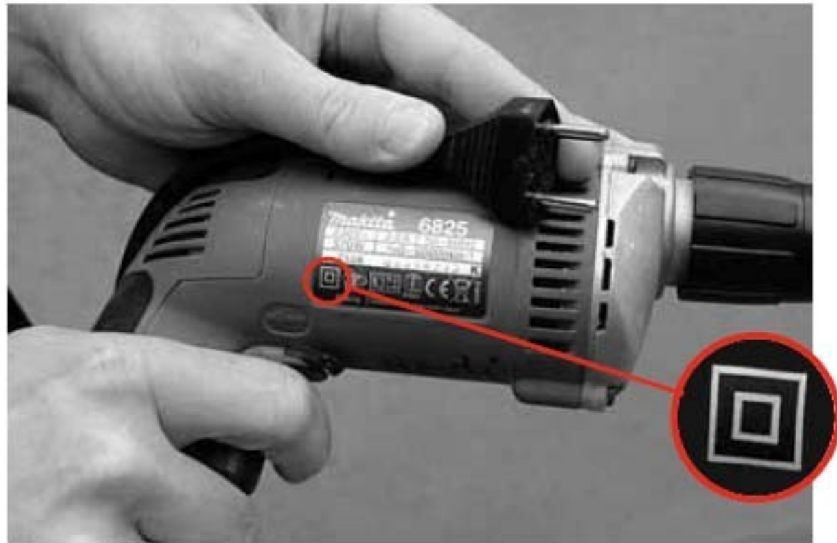
Fig. 1: trapano della classe di protezione II, con apposito contrassegno.
