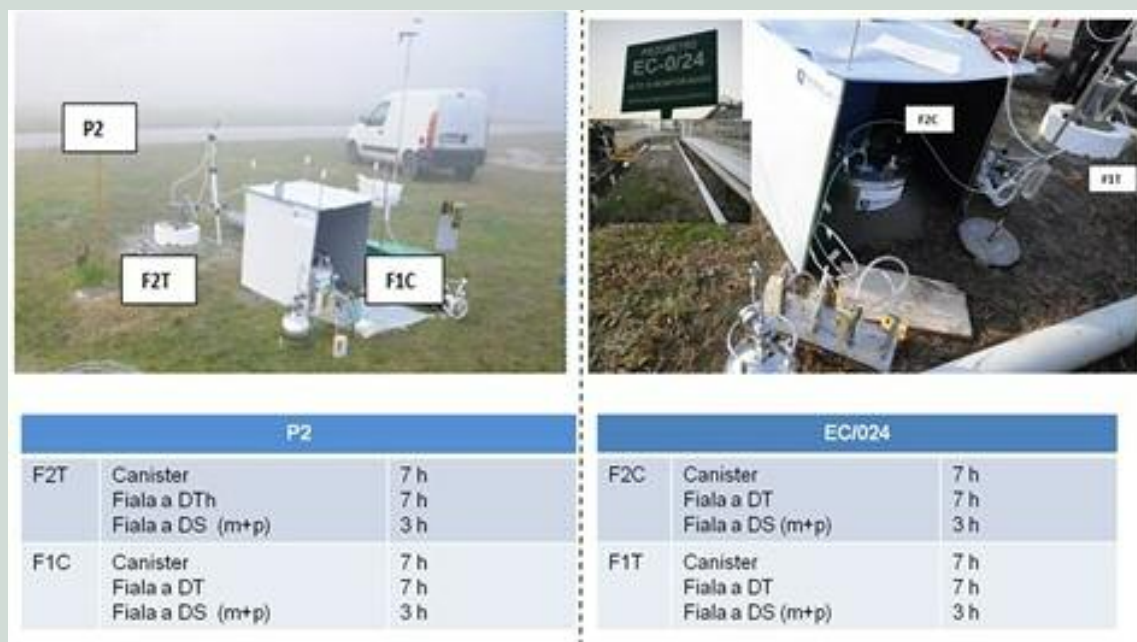
Figura 3: Misure contestuali con diverse tipologie di camere di flusso e diversi supporti di campionamento
