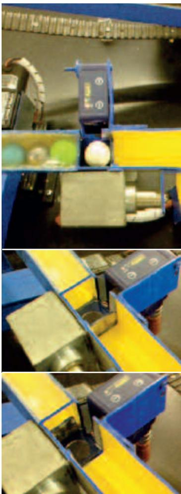
Tale programma dovrà gestire un sistema denominato “Dream Machine” di automazione e stoccaggio, in grado di riconoscere e selezionare quattro palline secondo un ordine predefinito attraverso il riconoscimento del colore e del tipo di materiale. Le palline, indipendentemente dall’ordine e dal colore, scendono lungo il profilato di convoglio e raggiungono la zona di rilevazione.
